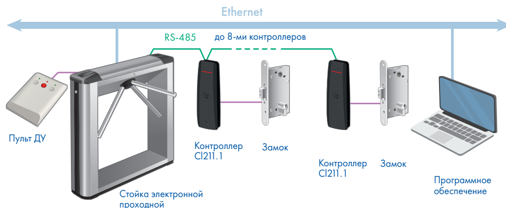
Структурная схема подключения электронной проходной
