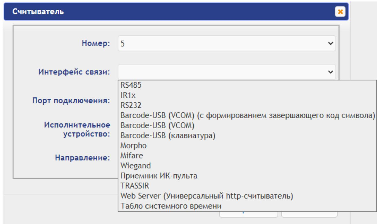
**Рисунок 2. Выбор типа интерфейса связи в Web-интерфейсе контроллера**
