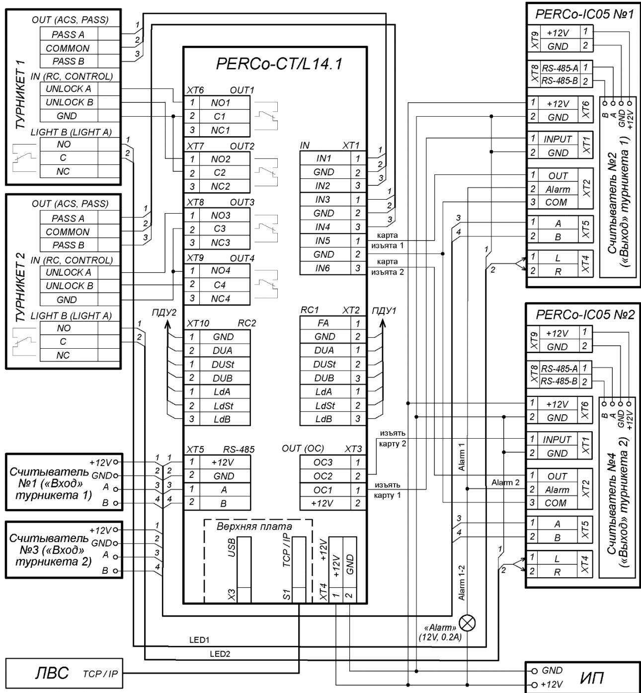
Рисунок 16. Схема подключения двух турникетов с картоприемниками PERCo-IC05
