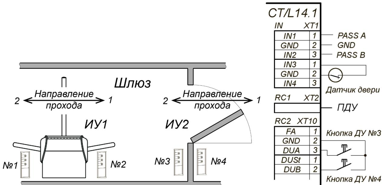
Рисунок 23. Схема шлюза из турникета и замка
