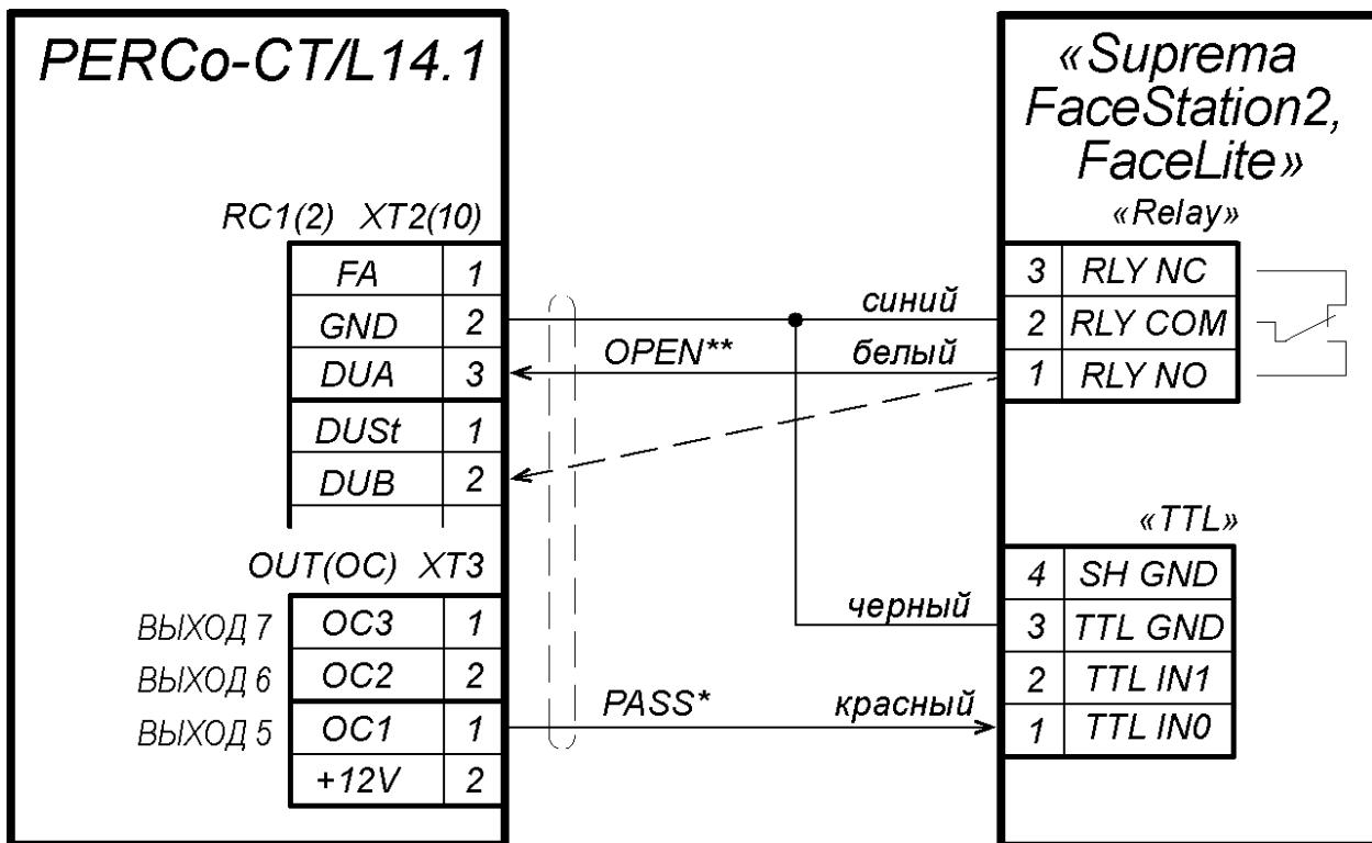
\* - для сигнала PASS может быть использован любой свободный выход контроллера CT/L14 (тип выхода - «Обычный»), для него в Web-интерфейсе необходимо задать внутреннюю реакцию:
