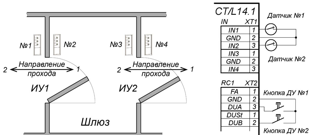
Рисунок 21. Схема шлюза из замков
