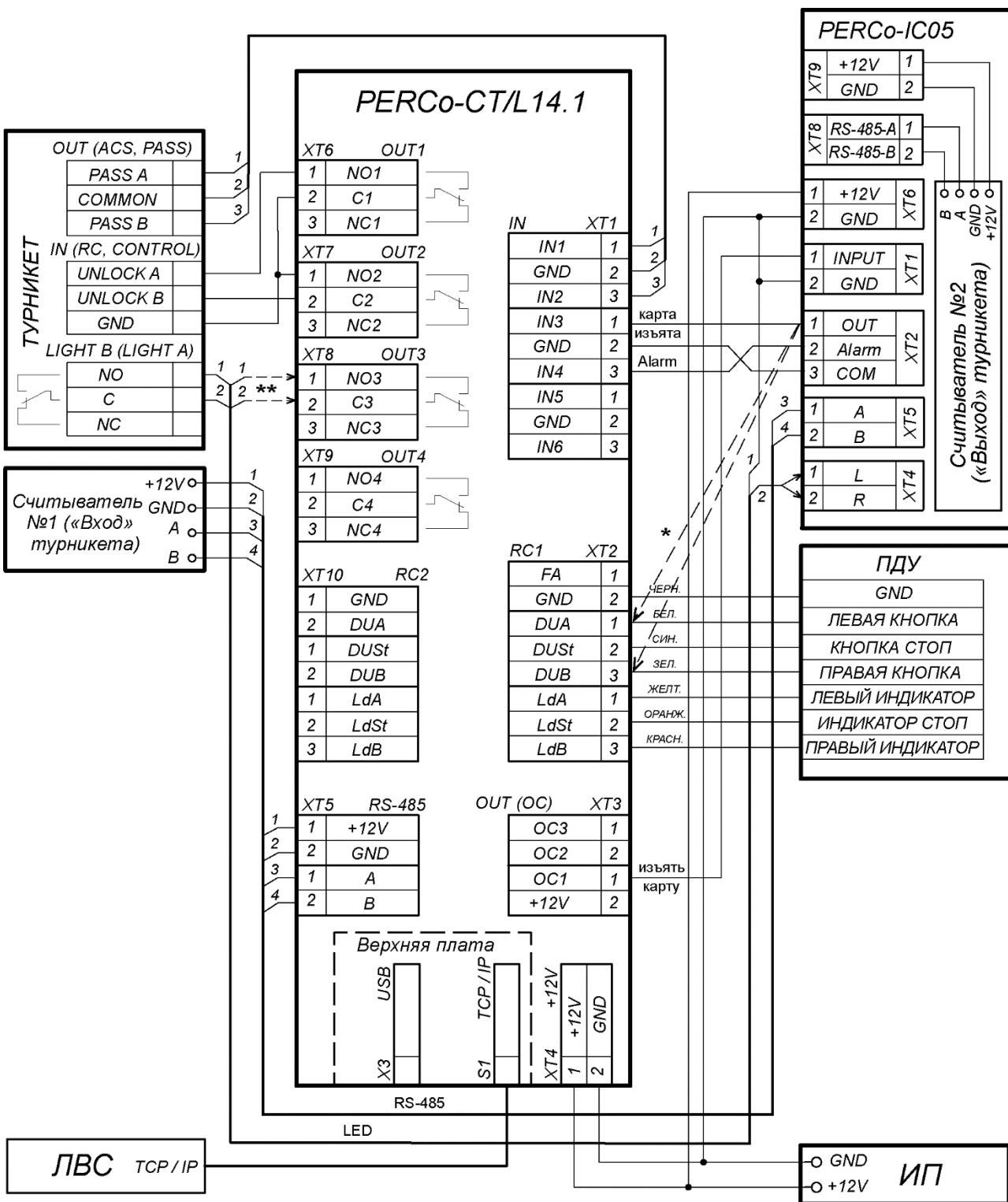
Рисунок 15. Схема подключения картоприемника PERCo-IC05
