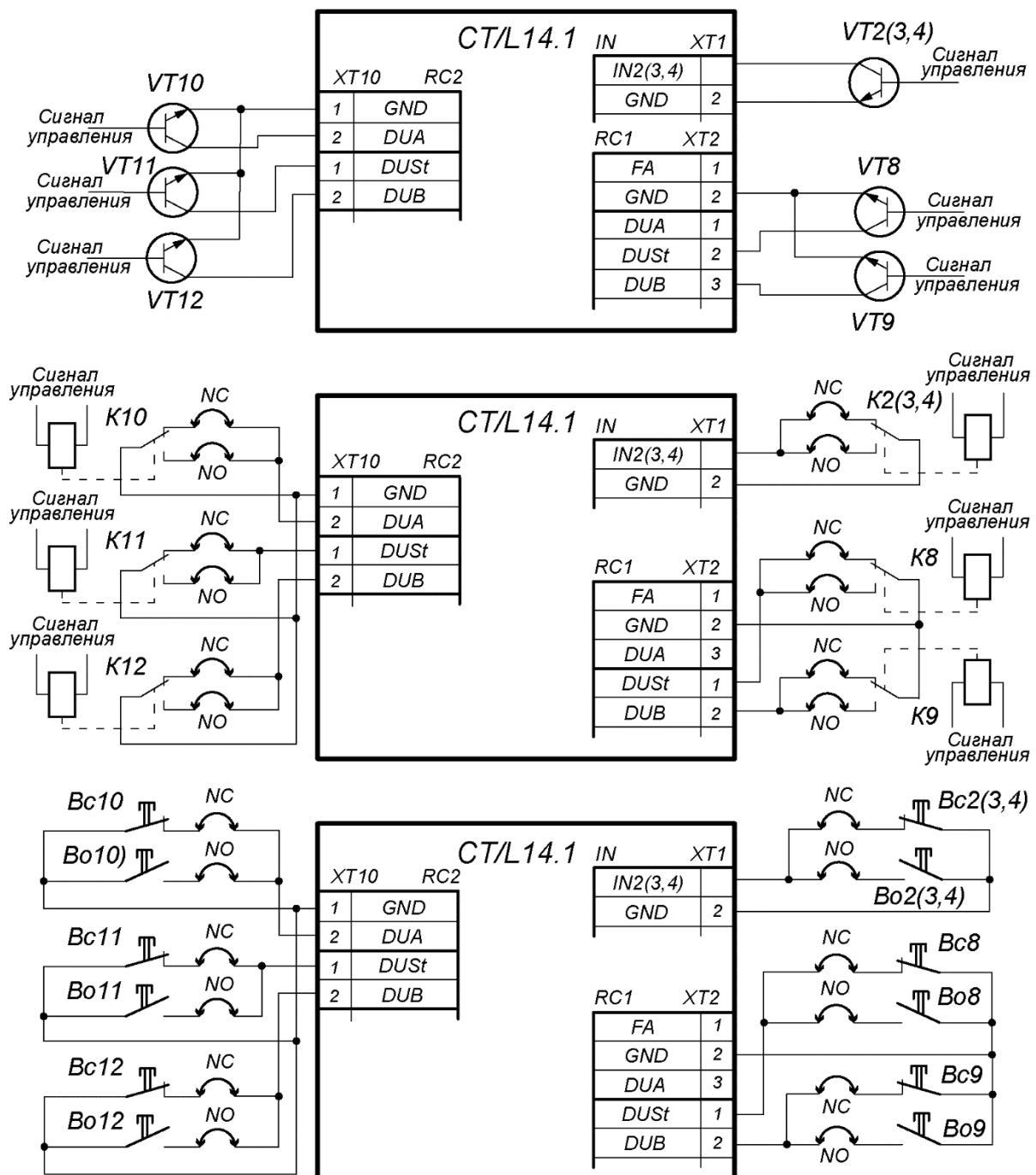
Рисунок 14. Схема подключений доп. оборудования к входам контроллера
