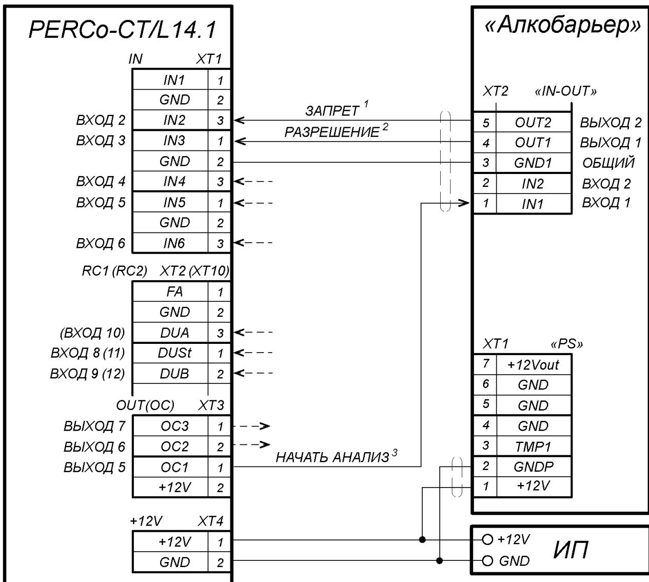
1, 2 - для подключения выходов алкотестера РАЗРЕШЕНИЕ и ЗАПРЕТ используются два разных входа контроллера из любых свободных,
