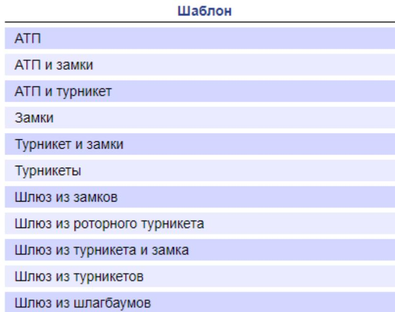
Для контроллера **PERCo-CT/L14.1** доступны следующие шаблоны конфигурации:
