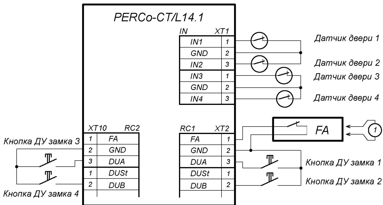
(1) – провод-перемычка, устанавливается при отсутствии устройства *FA*
